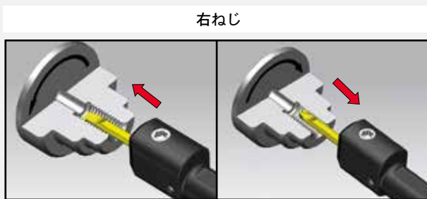
右ねじ インサート：右勝手の主軸 回転方向：時計回り 送り方向：外→内
