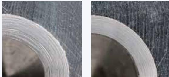
一般的工具での加工面      SpyroTecでの加工面
